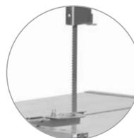
Serrage constant et optimal du ruban de scie assurant une excellente précision de coupe et une grande longévité
