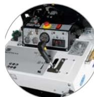
Déplacement sûr de la scie grâce à la position point mort
