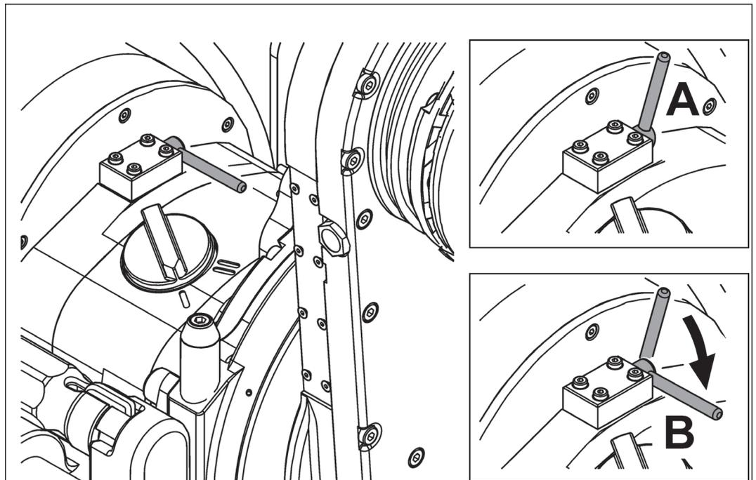
A ⇒ Le débrayage de sécurité s'est déclenché.
