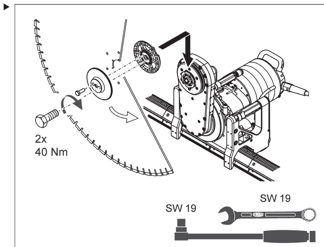
**3.4.4 Fixation pour coupe normale avec lames de scie de Ø supérieur à 1 000 mm**
