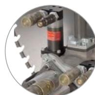
Tête de scie robuste avec moteurs hydrauliques standard
