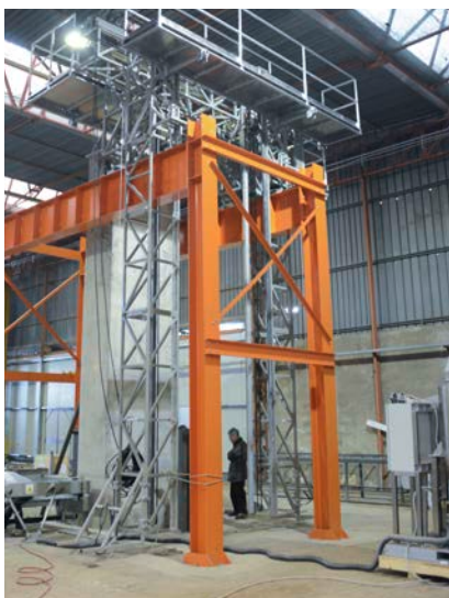
Grote, stationaire kabelzagen voor de nucleaire industrie, ontwikkeld door Studio Corvi.
