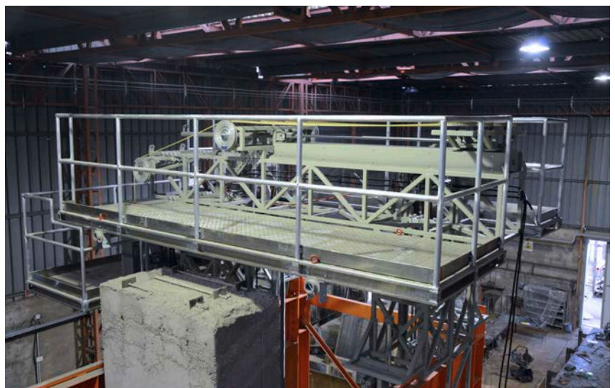
Grote, stationaire kabelzagen voor de nucleaire industrie, ontwikkeld door Studio Corvi.
