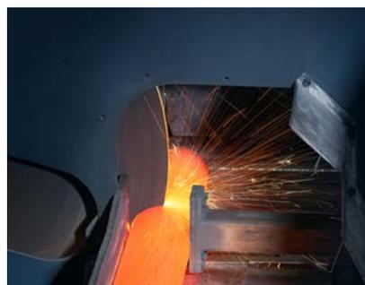
**Leader du marché dans l'industrie de l'acier** — Nous sommes les producteurs les plus convoités des disques à tronçonner les plus grands du monde avec des diamètres allant jusqu'à 2 000 mm pour tronçonner des produits semi-finis en acier.
